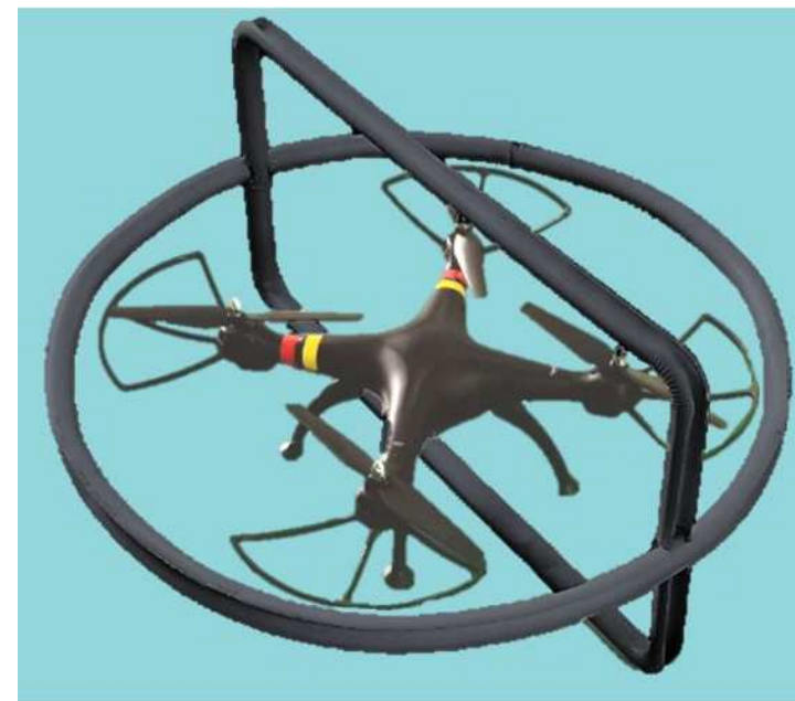
カバーにドローン実機を取付けた後のイメージ (エアバッグが格納された状態)
