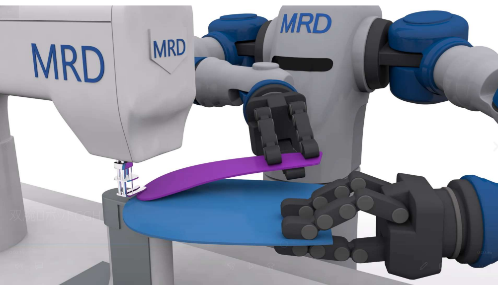
③マニピュレータでパーツを挟んで縫製
